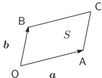
$$\Rightarrow S = \begin{cases} \begin{vmatrix} a_1 & b_1 \\ a_2 & b_2 \end{vmatrix} & \mathbf{a}, \mathbf{b} \text{ が右手系のとき} \\ - \begin{vmatrix} a_1 & b_1 \\ a_2 & b_2 \end{vmatrix} & \mathbf{a}, \mathbf{b} \text{ が左手系のとき} \end{cases}$$
