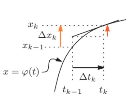
$$\lim \frac{\Delta x}{\Delta t} = \frac{dx}{dt} \text{ だから } \Delta x \doteq \frac{dx}{dt} \Delta t$$
