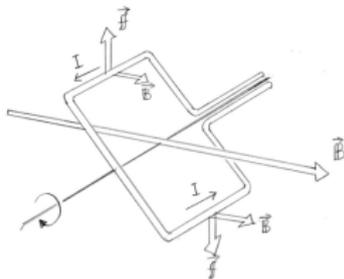
図のような針金のループには図のように回転させようとする力 (トルク) が働く。これが直流モーターの原理である。
