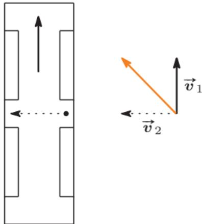
走行中の電車内で右のドアから左のドアに歩いて移動している人がいる。電車の走行速度を  $\vec{v}_1$ , 人の歩く速度（電車に対する相対速度である）を  $\vec{v}_2$  とすると, 人の地面に対する速度は  $\vec{v}_1 + \vec{v}_2$  となる。
