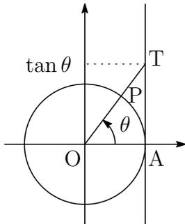
原点中心半径 1 の円に点  $A(1, 0)$  で接線を引く。P を円周上 A から角  $\theta$  だけ回転した点とし, OP の延長線と接線の交点を T とする。
