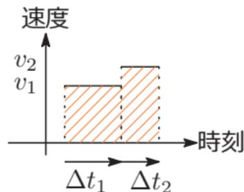
位置の変化量 =  $v_1 \Delta t_1 + v_2 \Delta t_2 = \square$  の面積
