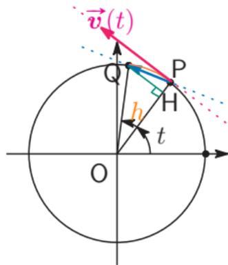
[確かめ] (i)  $\vec{v}(t)$  の向きは接線方向で正の回転の向きである. なぜなら直線 PQ は  $h \rightarrow 0$  のとき接線に近づくから.
