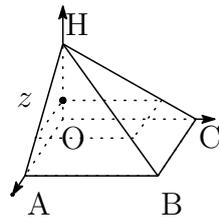
これは  $OABC$  を底面とする高さ  $h$  の錐体である。底面積  $S$  は  $S = ab$ , 高さ  $z$  で  $xy$  平面に平行に切った切り口の面積を  $S(z)$  とすると底面と切り口は相似で
