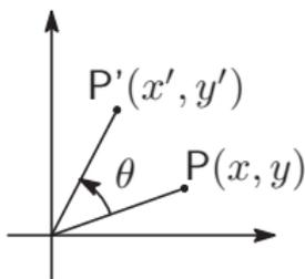
原点の周りで点を  $\theta(\text{rad})$  回転させる変換  $f$  は線形変換であり
