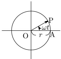
角速度が  $\omega$  だから P は時刻  $t$  には円周上を A から  $\omega t$  ラジアン回転したところに来る。だから  $(r \cos \omega t, r \sin \omega t)$  である。
